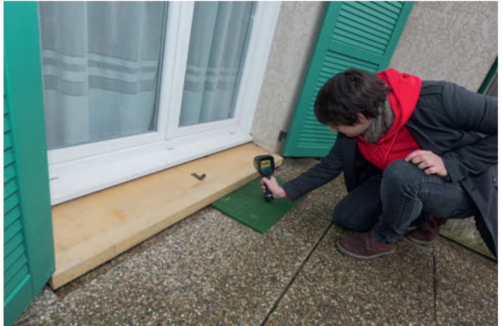
↑ Dans le viseur de Philippe Combas, les éventuelles pertitions énergétiques des maisons des Messins.
